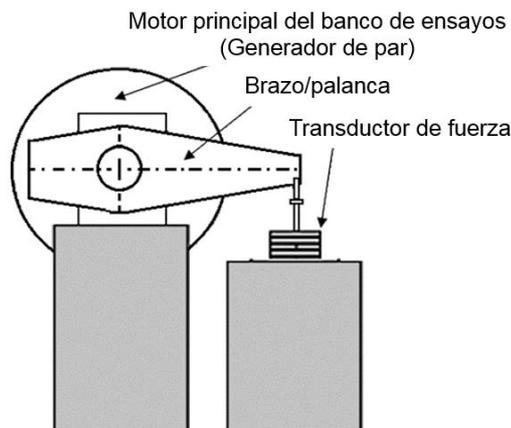
Sin embargo, estos sistemas trabajan habitualmente de manera estática. Por el contrario, el patrón a montar en el banco de ensayos estará sufriendo la rotación generada por el motor principal. Por ello, se ha dividido en dos partes con extremos bridados para su montaje en el banco de ensayos, asegurando de esta forma que gire de manera solidaria al resto de elementos de la cadena de transmisión (Figura 11).
