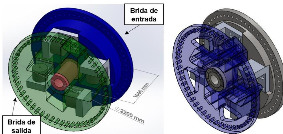
En un extremo se encuentran acoplados los soportes para los cuatro transductores de fuerza empleados. En el otro extremo se han mecanizado los 4 brazos que harán contacto con los transductores, aseguran la transmisión del movimiento y la medición del par generado.
