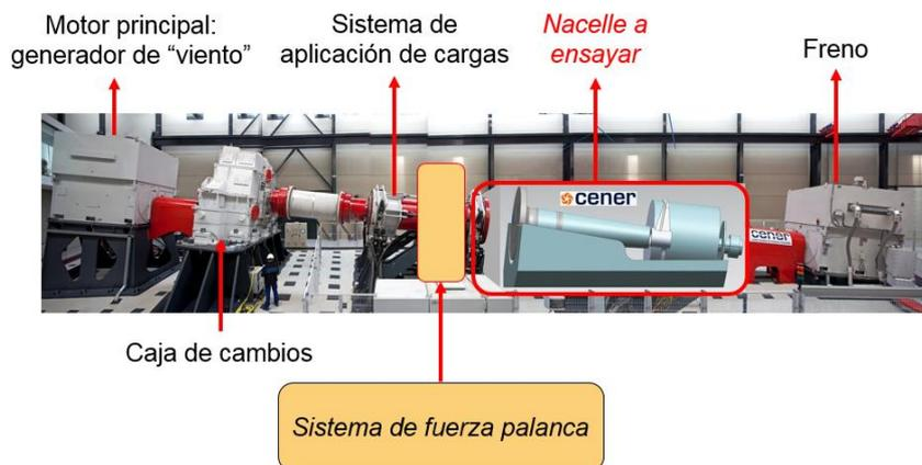
En la actualidad, dada la falta de mediciones directas de par de torsión mediante métodos trazables, los operadores de los bancos de ensayo emplean medidas eléctricas y modelos matemáticos para determinar el par de torsión y las pérdidas que tienen lugar en la cadena de transmisión.
